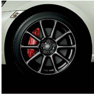
Brembo 製 17 インチベンチレーテッド ディスクブレーキ &専用 17 インチアルミホイール
