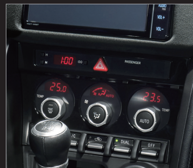
ダイヤル式ヒーターコントロールパネル (ピアノブラック加飾)
