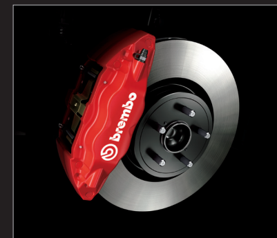
brembo製17インチベンチレーテッド ディスクブレーキ(フロント・リヤ)
