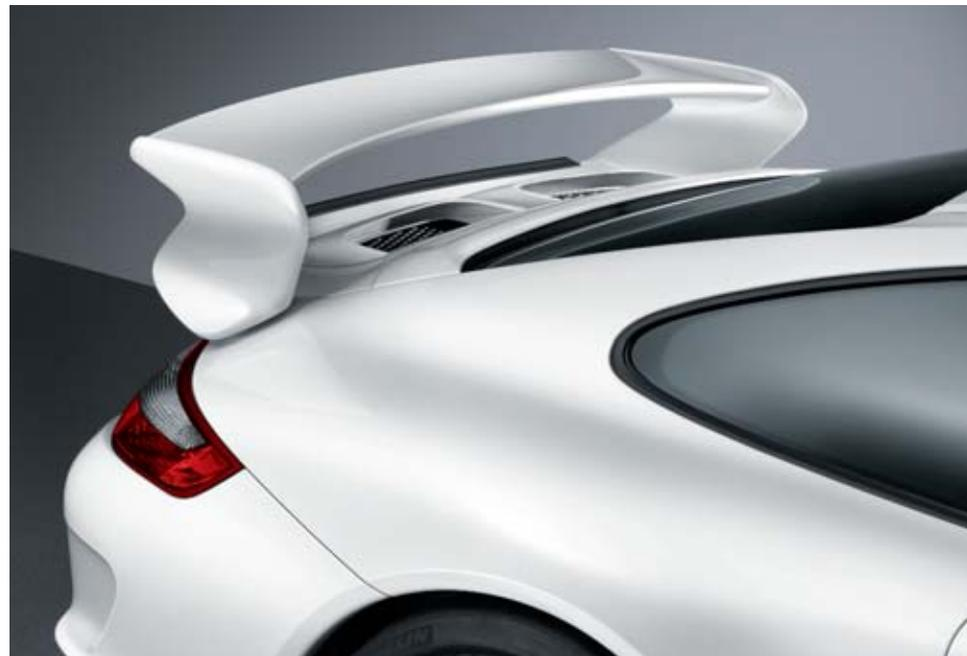
Ein feststehender Doppelflügel dominiert das Heck. Das obere Flügelprofil ist für den Rundstreckeneinsatz im Neigungswinkel verstellbar. Der Doppelflügel sorgt auch bei Höchstgeschwindigkeit für die nötige Fahrstabilität. Ein sehr wirksames Detail: eine zusätzliche Gummilippe (die sogenannte Gurney Flap) auf dem unteren Flügel, die als zusätzliche Abrißkante dient.
