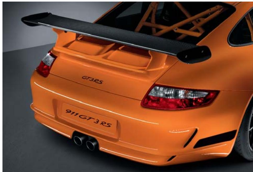
Das Design des Heckflügels ist beim neuen 911 GT3 RS an die 911 GT3 Cup Fahrzeuge angelehnt. Er ist aus Kohlefaser (CfK) und damit leichter als beim 911 GT3. Zugleich ist er größer – für noch mehr Abtrieb hinten. Wie beim 911 GT3 ist er verstellbar. Für gute Fahrstabilität auch bei hohen Geschwindigkeiten.
