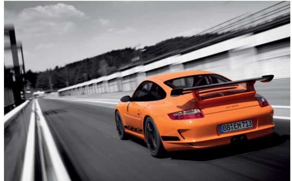
Genau wie der 911 GT3 verfügt der neue 911 GT3 RS serienmäßig über leichte 19-Zoll GT3 Räder. Durch die verringerte Einpreßtiefe der Räder an der Hinterachse besitzt der neue 911 GT3 RS eine um 34 mm breitere Spur und damit eine nochmals erhöhte Wankstabilität. Straßenzugelassene Sportreifen sorgen für die nötige Traktion.
