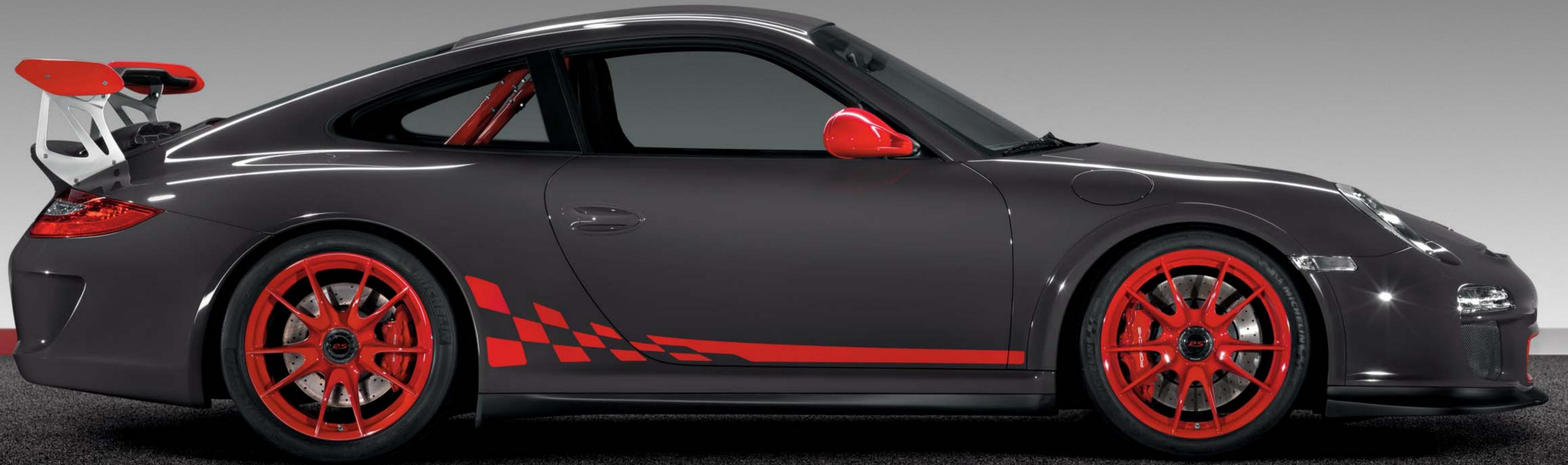
Der Heckdeckel mit GT3 RS Schriftzug und die Heckscheibe sind aus leichtem Kunststoff. Genau wie das neue Heckmittelteil. Typisch: der zusätzliche große Lufteinlass auf dem Heckdeckel (Ram Air). Für eine nochmals verbesserte Kühlung und Luftansaugung.
