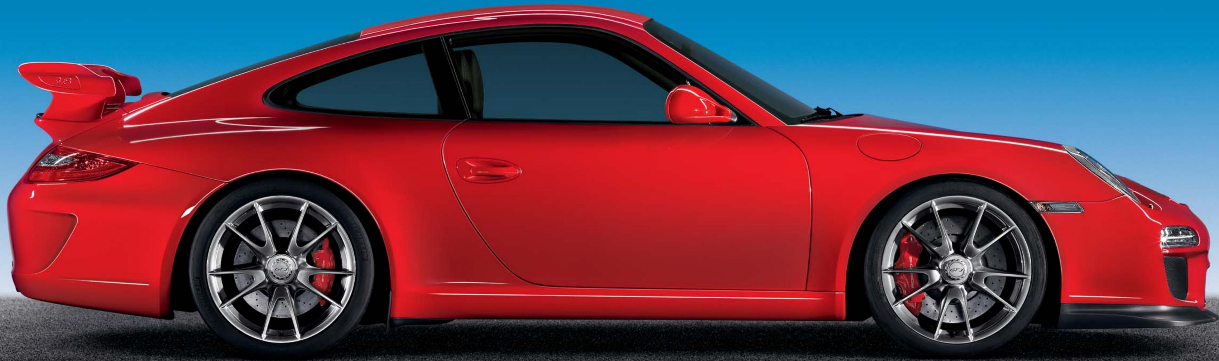
Die markanten LED-Heckleuchten sind weit in die Kotflügel gezogen und laufen spitz nach außen zu. Unverkennbar – genau wie der feststehende Doppelflügel. Er sorgt für aerodynamischen Abtrieb und hohe Fahrstabilität auch bei Höchstgeschwindigkeit. Hergestellt in Sandwichbauweise. Gefertigt aus Leichtbau-Kunststoff. Das spart Gewicht. Das obere Flügelprofil ist für den Rundstreckeneinsatz im Neigungswinkel verstellbar. In die
