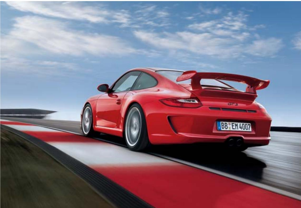
Alles am 911 GT3 ist auf Leichtbau ausgelegt. Die Türen und die Kofferraumhaube sind beispielsweise aus Aluminium, der Heckdeckel aus Kunststoff. Ergebnis: ein spezifisches Leistungsgewicht von lediglich 3,2 kg/PS. Aber damit nicht genug: Speziell für den Rundstreckeneinsatz bietet Porsche anstelle der konventionellen Batterie eine optionale Lithium-Ionen-Batterie (S. 75) an. Der Hauptvorteil: eine Gewichtsersparnis von über 10 kg.
