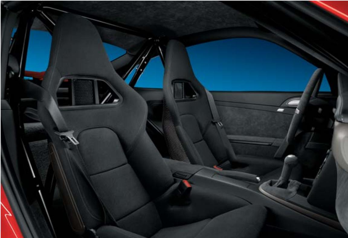
Es besteht aus einem mit der Karosserie verschraubten Überrollkäfig hinter den Vordersitzen, einem beigelegten 6-Punkt-Gurt in Rot für die Fahrerseite, einem beigelegten Feuerlöscher mit Halterung sowie einer Vorrüstung für den Batterie Hauptschalter.
