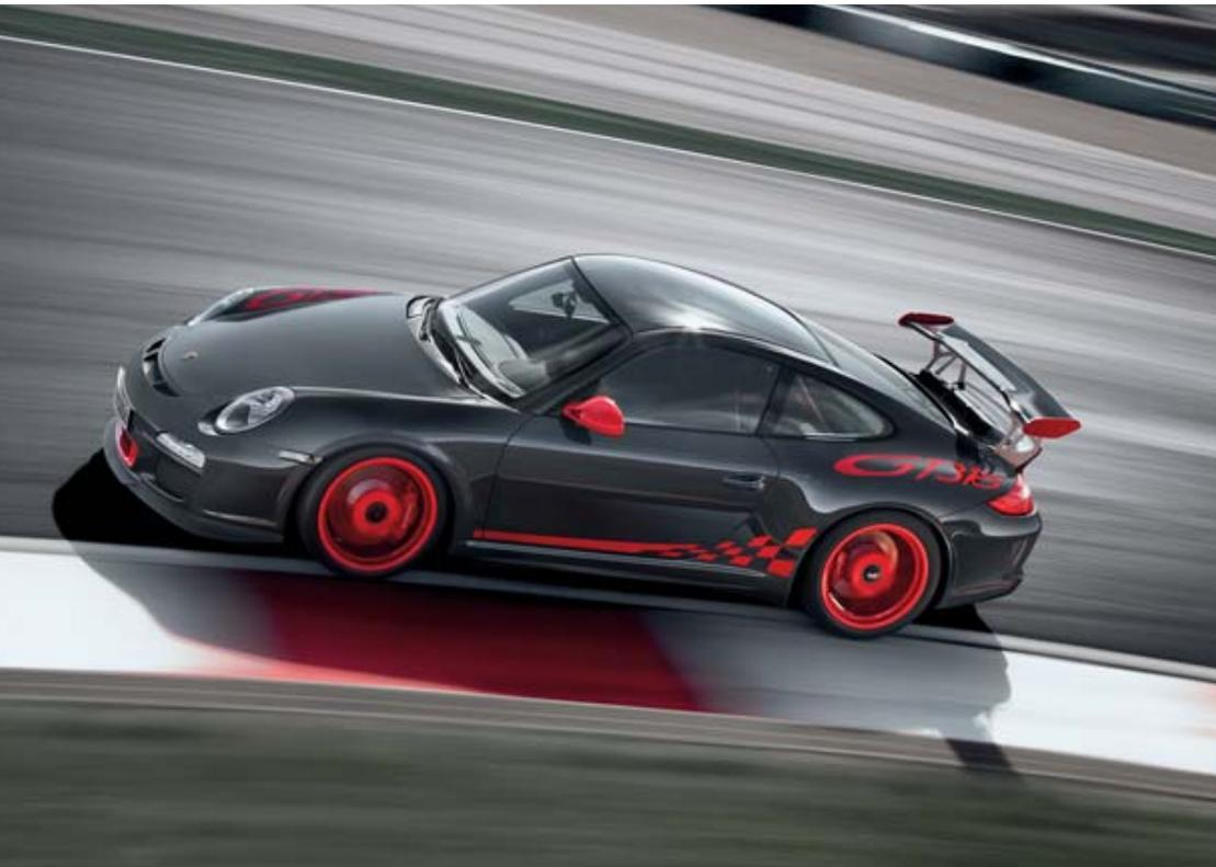
Leichtbau – natürlich. Beginnen wir mit dem Ergebnis: ein spezifisches Leistungsgewicht von lediglich 3,0 kg/PS. Erreicht durch die Verwendung motorsporttypischer Materialien wie Titan, Aluminium und Carbon. Zudem verfügt der neue 911 GT3 RS über leichte Türtäfel mit Öffnerschlaufen und eine Heckscheibe aus Kunststoff. Für den Einsatz auf der Rundstrecke bietet Porsche erstmals eine optionale Lithium-Ionen-Batterie an (S. 75). Über 10 kg können so zusätzlich eingespart werden.
