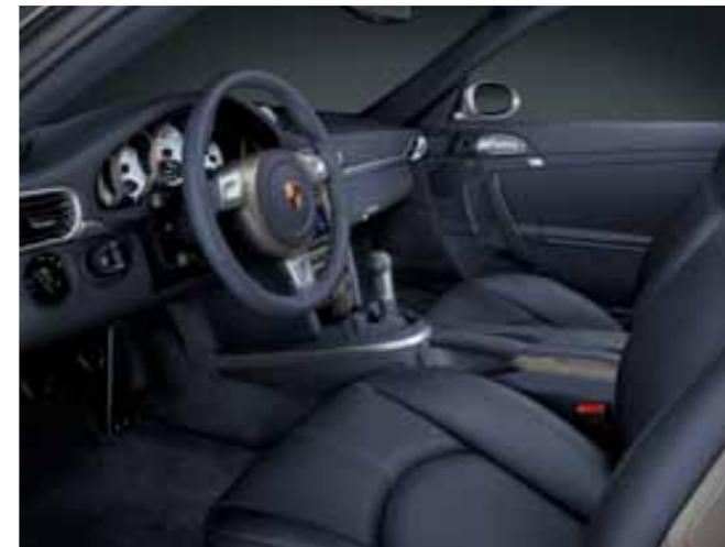
Sportlenkrad, das bis zu 40 mm axial und vertikal verstellbar ist, sind serienmäßig. Auf Wunsch erhalten Sie ein 3-Speichen-Lenkrad mit Multifunktionseinheit.
