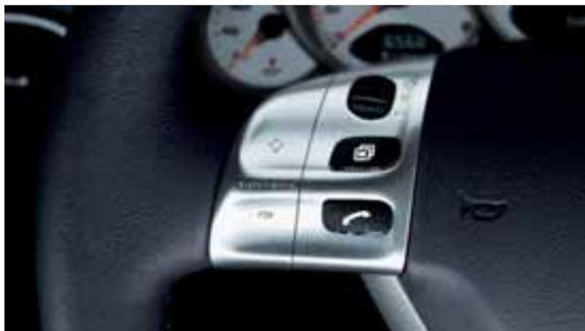
Tiptronic S Wipptaste im Lenkrad
