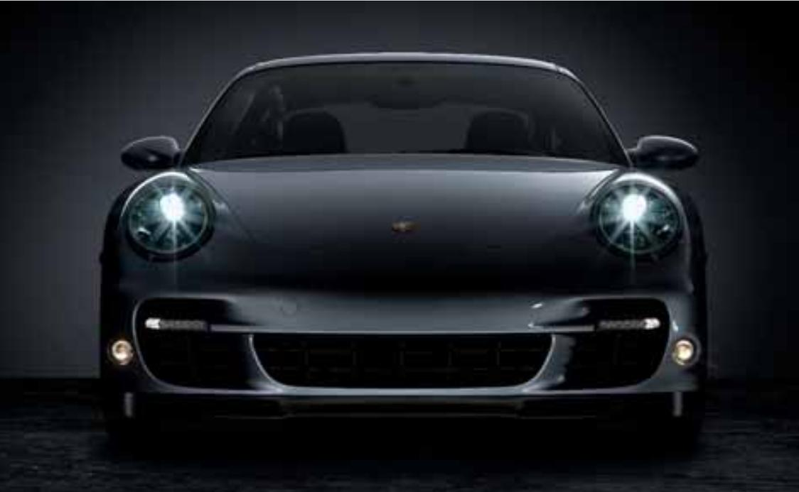
Beim 911 Turbo serienmäßig: eine Bi-Xenon-Scheinwerferanlage mit tageslichtähnlicher Lichtfarbe. Die kompakten Hauptscheinwerfer sorgen für eine breite und homogene Ausleuchtung der Fahrbahn. Für mehr Sicherheit – besonders
