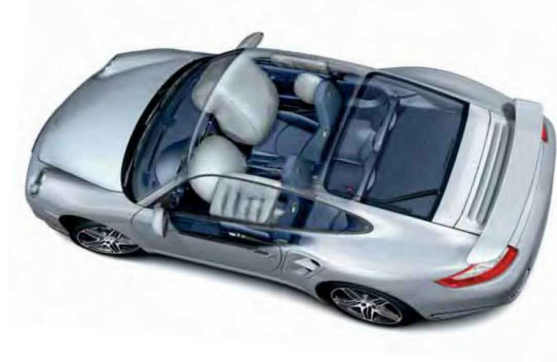
Beide Modelle verfügen serienmäßig über das Porsche Side Impact Protection System (POSIP). Es besteht aus 2 Seiten-Airbags pro Seite: In den Seitenwangen der Sitze ist ein Thorax-Airbag integriert, in den Türtafeln ein Kopf-Airbag. Mit einem Volumen von je ca. 8 Litern beim Thorax-
