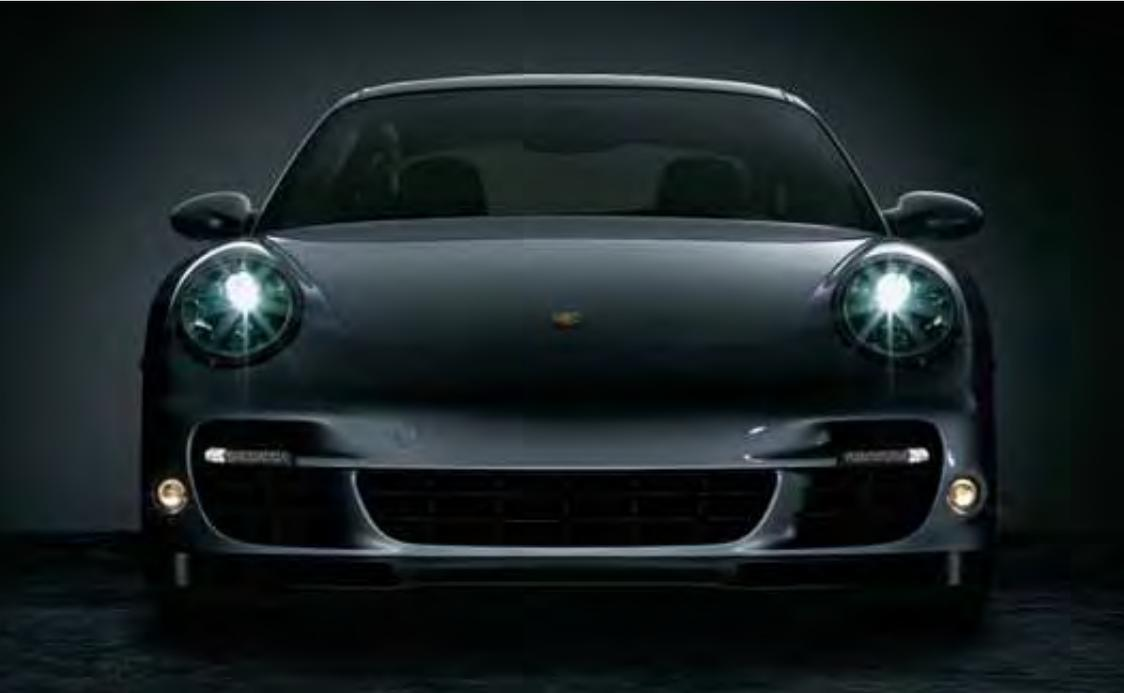
Bei den 911 Turbo Modellen serienmäßig: eine Bi-Xenon-Scheinwerferanlage mit tageslichtähnlicher Lichtfarbe. Die kompakten Hauptscheinwerfer sorgen für eine breite und homogene Ausleuchtung der Fahrbahn. Für mehr Sicherheit –
