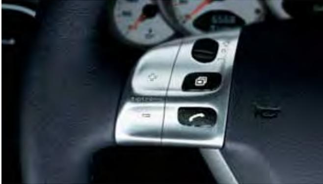
Tiptronic S Wipptaste im Lenkrad
