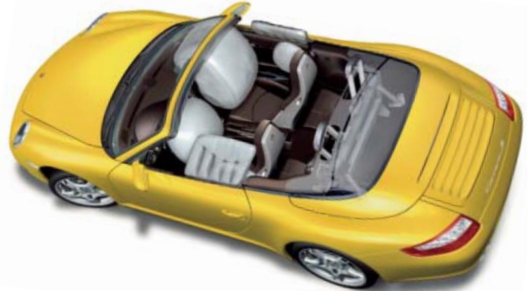
gungsänderungen der Karosserie, Längs- und Querschleunigung sowie den Kontakt zur Fahrbahn. Im Notfall löst er in Bruchteilen von Sekunden die gepolsterten Überrollbügel aus.
