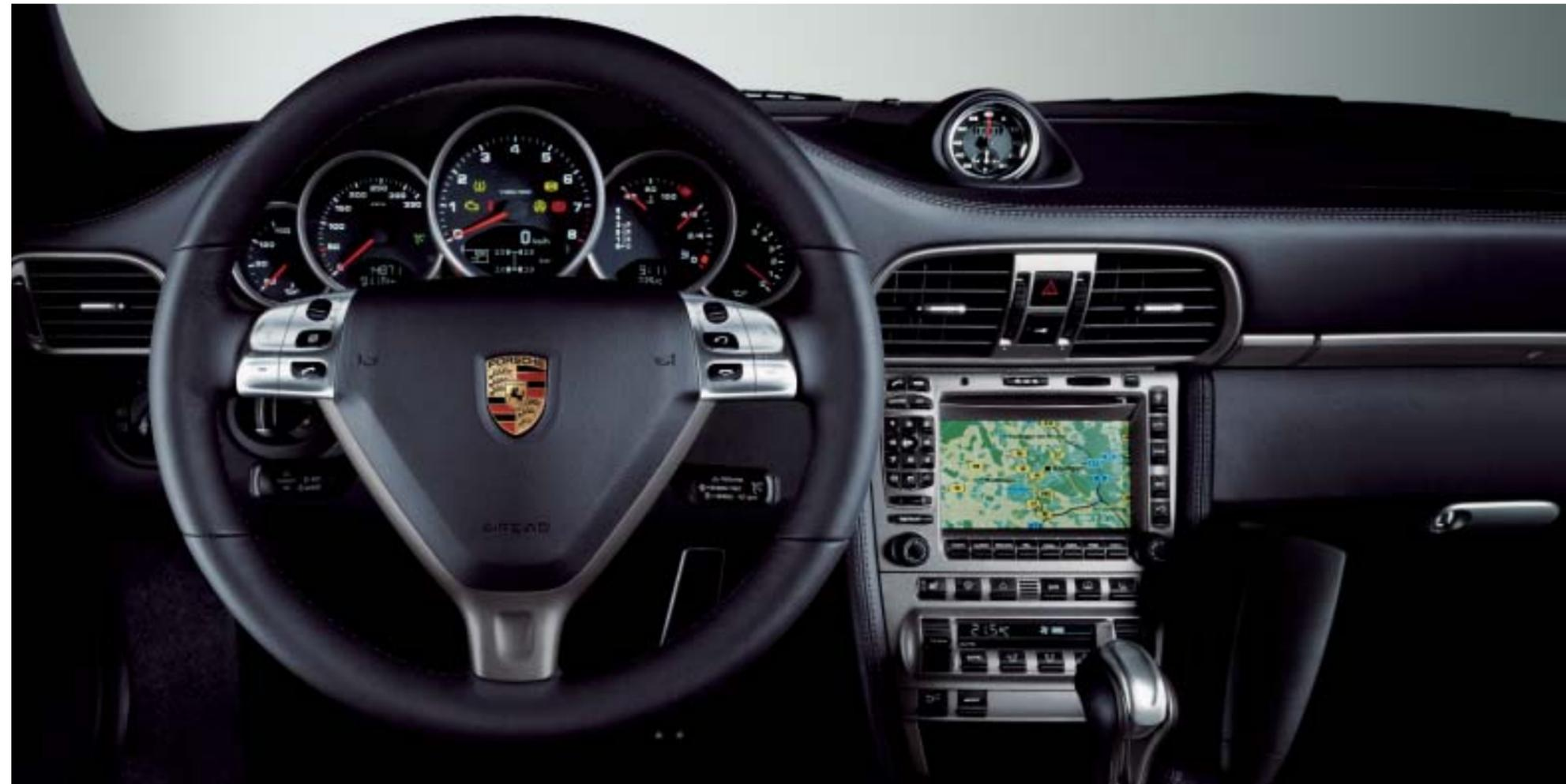
Schalttafel 911 Carrera mit Individualausstattungen, u. a. Lederausstattung, Multifunktionslenkrad, Sport Chrono Paket Plus, Tiptronic S, Tempomat, Navigationsmodul, Telefonmodul, Passivhörer und Reifendruckkontrollsystem (RDK)
