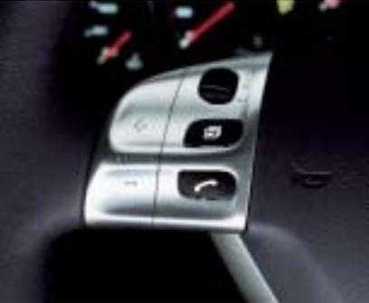
Tiptronic S Wipptaste im Lenkrad
