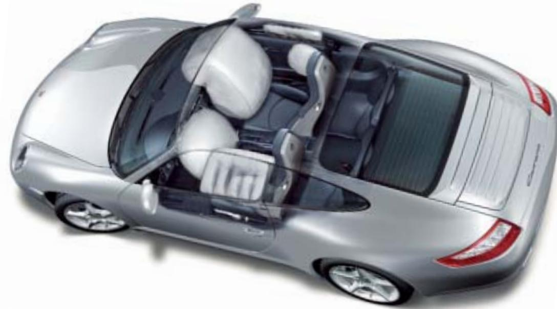
Zur Erkennung von Unfallschwere und -richtung sind zusätzlich zur Zentraleinheit auf dem Mitteltunnel 2 zusätzliche Sensoren im Bereich der Scheinwerfer montiert. Ein Crash wird deutlich früher und genauer erkannt und ausgewertet. Der 911 verfügt serienmäßig über die neueste Generation des Porsche Side Impact Protection
