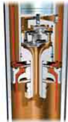
Druckstufe – nur Arbeitskolben, kompromißlos-sportliche Abstimmung
