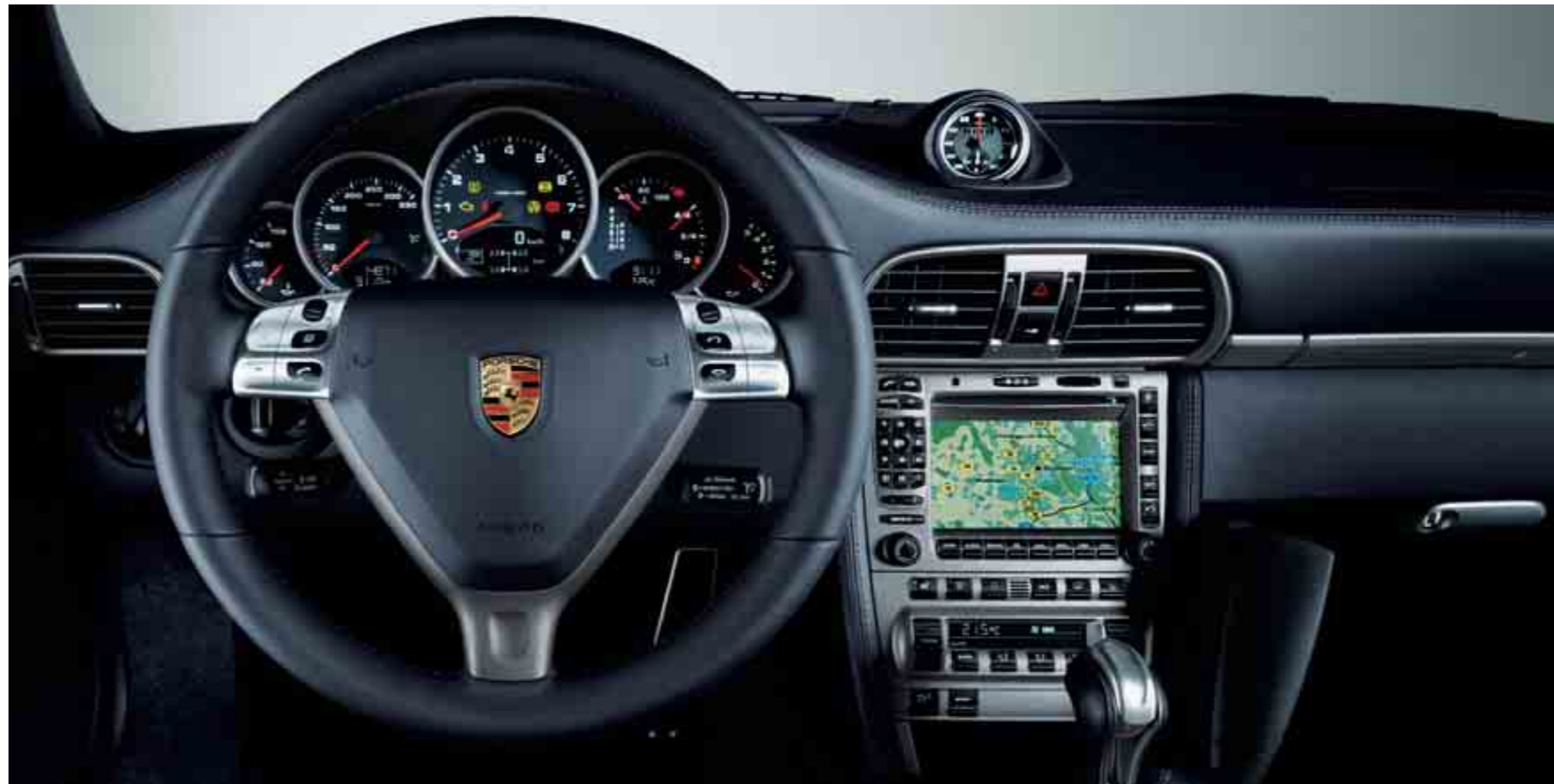
Schalttafel 911 Carrera/911 Targa 4 mit Individualausstattungen, u. a. Lederausstattung, Multifunktionslenkrad, Sport Chrono Paket Plus, Tiptronic S, Tempostat, Navigationsmodul, Telefonmodul, Passivhörer und Reifendruckkontrollsystem (RDK)
