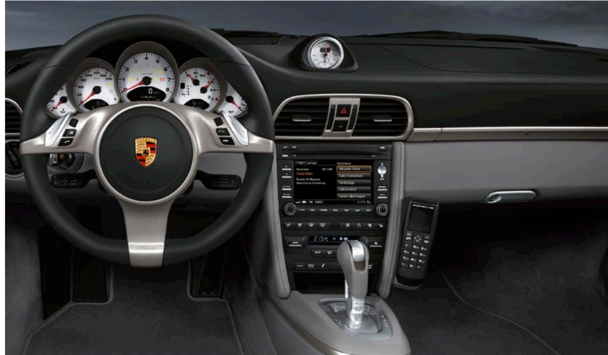
Schalttafel 911 Carrera S/911 Targa 4S mit Individualausstattungen, u.a. Lederausstattung in Bi-Color, PDK, Sport Chrono Paket Plus, Tempostat, Navigationsmodul, schnurlosem Bedientaster für Telefonmodul und Reifendruckkontrollsystem (RDK)
