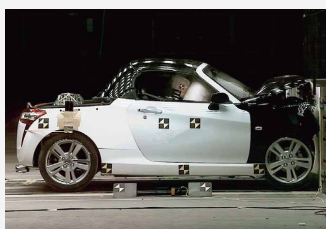
55km/h前面衝突実験
