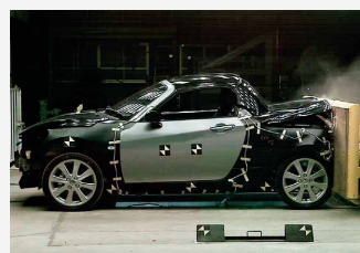
55km/h後面衝突実験
