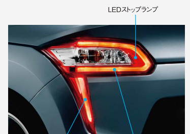
LEDリヤエクストラテールランプ LEDストップランプ/テールランプ
