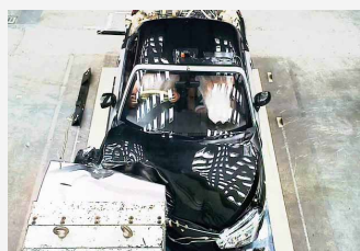
64km/hオフセット衝突実験
