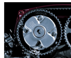
MIVEC [連続可変バルブタイミング] システム
