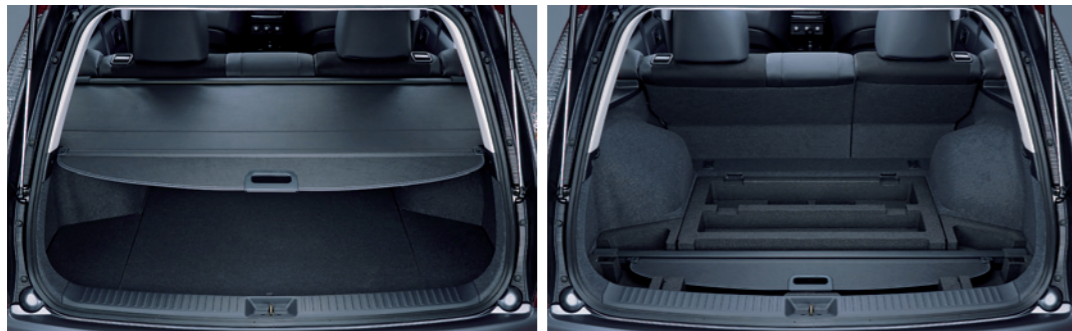
使いやすさと、収納しやすさに工夫がある。スライド式トノカバー (リヤシートリクライニング対応) ワンタッチで取り付け位置を後方に移動できるため、リヤシートをリクライニングさせた際にも使用可能。使用しない時はトノカバーを取り外して、ラゲジフロアボックス内にぴったり収納できる。
