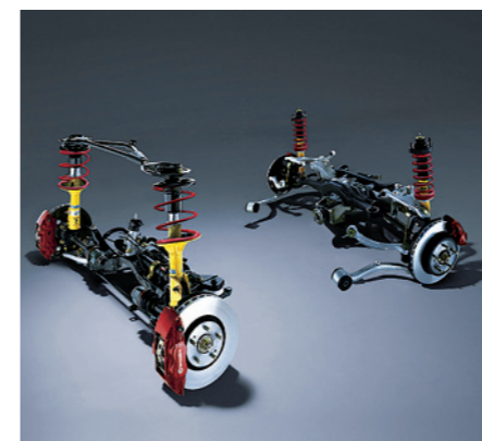
サスペンション(フロント: マクファーソンストラット式、リヤ: マルチリンク式)
