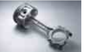
ピストン&コンロッド VIIIではトルク増強にともないピストンには高強度アルミ材を、コンロッドには高強度鍛造鋼を採用し耐久性を向上。
