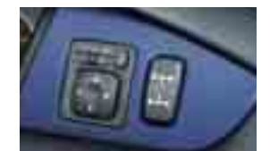
ACDモード切替スイッチ 路面状況にあわせ最適化した3つのオートモードから選択できる。
