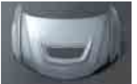
アルミ製フード&フロントフェンダー フードとフロントフェンダーには、 軽く強度に優れたアルミ素材を使用。
