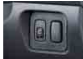
ディスチャージヘッドライト用レベルリングスイッチ(光軸角度調整) [GSR]
