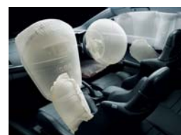
運転席&助手席SRSデュアルステージエアバッグ 運転席SRSニーエアバッグ・サイド&カーテンSRSエアバッグ
