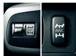
S-AWCモード切替スイッチ 左: ステアリングスイッチ 右: コンソールスイッチ (コンソールスイッチはGSR-Premium、GSR [メーカーオプションのHDDナビゲーションシステム装着時])
