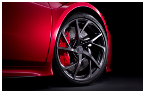
3次元切削のNSX専用鍛造アルミホイール
