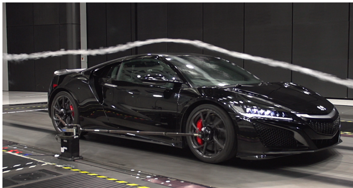
ボディー下面の空気流を走行状態で検証できるHRD Sakuraのムービングベルト式実車風洞
