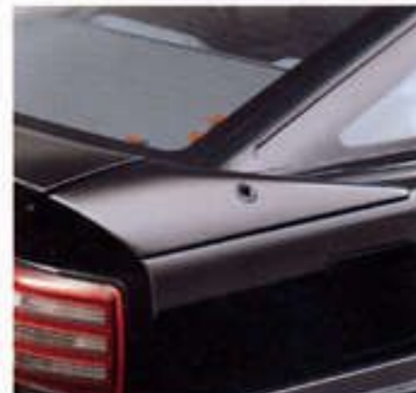
ダイバシティアンテナを採用。受信感度を向上させ、よりクリアな音を室内に。3.0GTターボ系に標準装備。 ダイバシティアンテナ ※8 ダイバシティアンテナは、ウインド処理の込みアンテナをメインに、ポールアンテナをサブとし、強い電波を受信しているアンテナを選択して、自動的に切り替えるもの。
