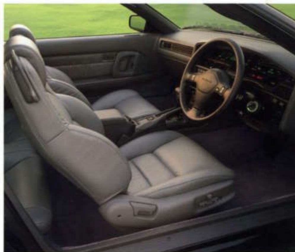
COCKPIT (3.0GT TURBO LIMITED) Instrument panel: PANORAMIC DIGITAL METER seat: 8WAYS ADJUSTABLE WITH POWER CONTROL steering wheel: TILT & TELESCOPIC MEMORY STEERING WHEEL (POWER ASSISTED) PHOTO: 3.0GTターボリミテッド 本皮革巻き3本スポークステアリング CDプレーヤー&カセットデッキ(6スピーカー)はオプション オートエアコンは販売店装着オプション
