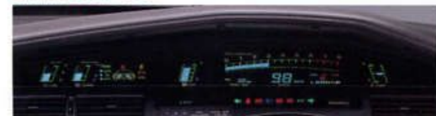
デジタルメーターが、走りを見覚的に捉える。判読性に優れた鮮やかなカラー表示。走行情報をリアルタイムに伝えてくれる。 パノラミックデジタルメーター ※1 3.0GTターボ系、GTツインターボ Electronics社標準に標準装備 PHOTO: 3.0GTターボリミテッド
