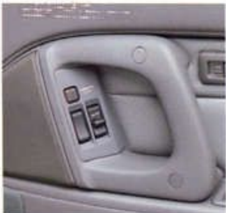
ウインドウ開閉もスムーズに。ワンタッチ式のパワーウィンドウは全車に標準装備。もちろんキーOFF後も作動可能だ。 ドアトリムドアアシストグリップ (パワーウィンドウスイッチ)
