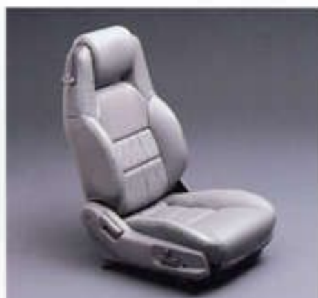
スーパーだからこそ許される最高の贅。本皮革パワースポーツシート。3.0GTターボ系ではシート・スライド、シート・クッション前部&後部、サイド・サポート、ランバー・サポートの調整機構を電動化。しかも今回、新たにメモリー機能を備えたパワーライニング機構も加わり、使用性の向上がさらに図られている。 本皮革パワースポーツシート ※4 3.0GTターボリミテッドにオプション
