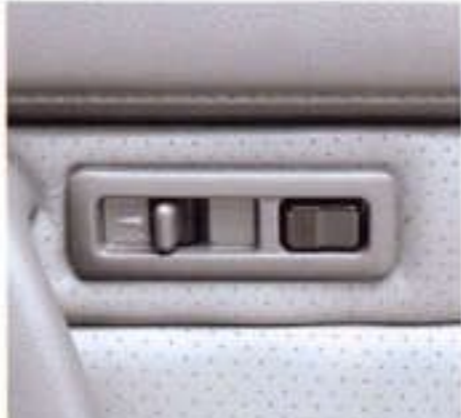
セーフティドライブにキメ細かな配慮。車速感応ドアロック。車速が20km/h以上になると自動的に運転席・助手席のドアが旋錠される画期的なシステムだ。 電磁式ドアロックコントロール ※6 車速感応タイプは3.0GTターボ系に標準装備
