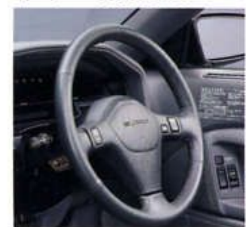
質感が漂うステアリングにGTの息吹が伝わる。3.0GTターボ系、2.0GTツインターボにはスポーティな本皮革巻きの3本スポークステアリングを装着。プッシュ式のオートドライブスイッチも操作性を考慮し、横スポーク部に配置した。 本皮革巻き3本スポークステアリング (オートドライブスイッチ付) ※3 3.0GTターボ系、GTツインターボ Electronics社標準に標準装備 PHOTO: 3.0GTターボリミテッド
